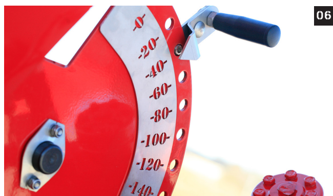
1 > BREDAL F8 2 > SPREDESYSTEMET med 2 bånd, 2 baglåger og 2 uafhængigt styrede nedløb 3 > ELEKTRISK REGULERET NEDLØB 4 > FØLER 5 > F8'ER set fra oven 6 > SKALA for baglåge
